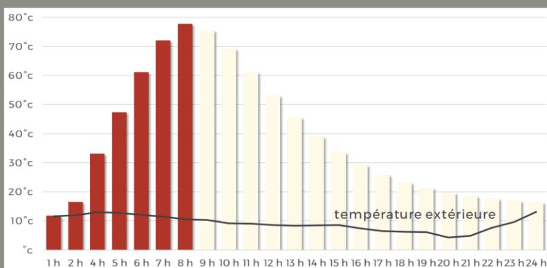
Pendant la flambée, le poêle TERRASTONE réchauffe l'habitation grâce au circuit de convection ménagé à l'intérieur de l'appareil. Simultanément, une partie des calories émises par le foyer sont stockées dans la double enveloppe.
