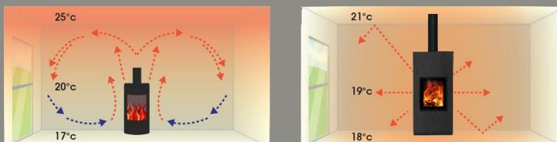
En diffusant les calories par rayonnement, le poêle TERRASTONE ne provoque pas de brassage d'air et de poussière.
